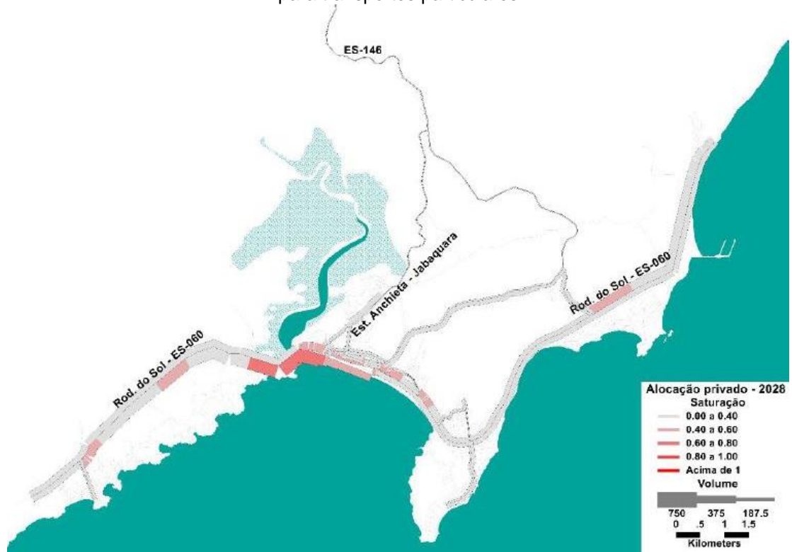
Figura 51: Carregamento e saturação da rede viária central de Anchieta em 2028 para o Cenário 1, para transportes particulares
