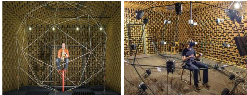
Figura 52: À esquerda, múltiplos canais ao redor da esfera gravando o sinal musical simultaneamente e medindo a direcionalidade do instrumento; à direita, ambiente anecoico de imersão na realidade acústica virtual.
