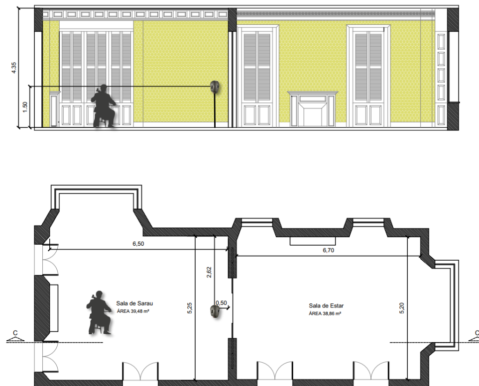
Figura 27: Planta baixa e corte esquemáticos contendo a representação do posicionamento dos músicos e do torso durante a gravação da performance musical na situação 01.
