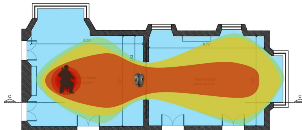
Figura 49: Esquema gráfico da redistribuição dos atributos acústicos na sala de sarau da Mansão Tavares Guerra, demonstrando a área de compressão da energia sonora.
