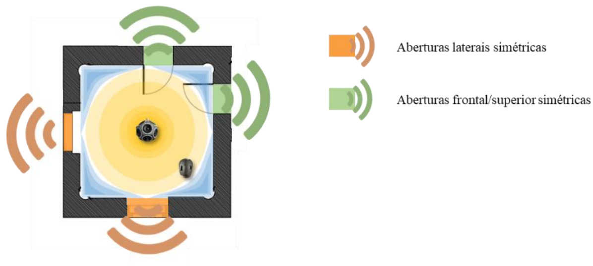
Figura 50: Esquema gráfico representado a propagação da energia sonora na sala de sarau da Villa Ferreira Lage e os vazamentos de energia sonora em função de suas tipologias de aberturas.
