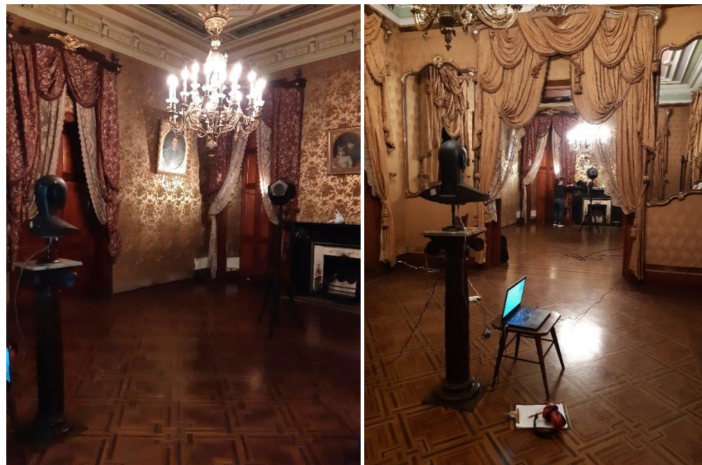
Figura 25: Registro do posicionamento da fonte e do torso durante e medição dos parâmetros de qualidade sonora nas situações 01 e 02 respectivamente.
