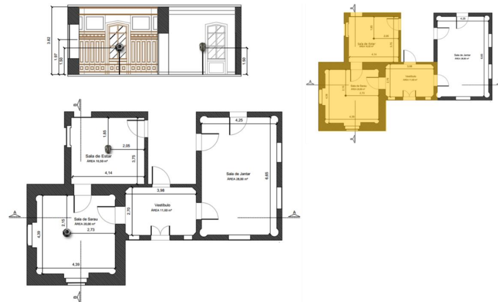
Figura 40: Planta baixa e corte esquemáticos contendo a representação do posicionamento da fonte e do torso e possibilidades de acoplamentos considerados durante e medição dos parâmetros de qualidade sonora na situação 02.
