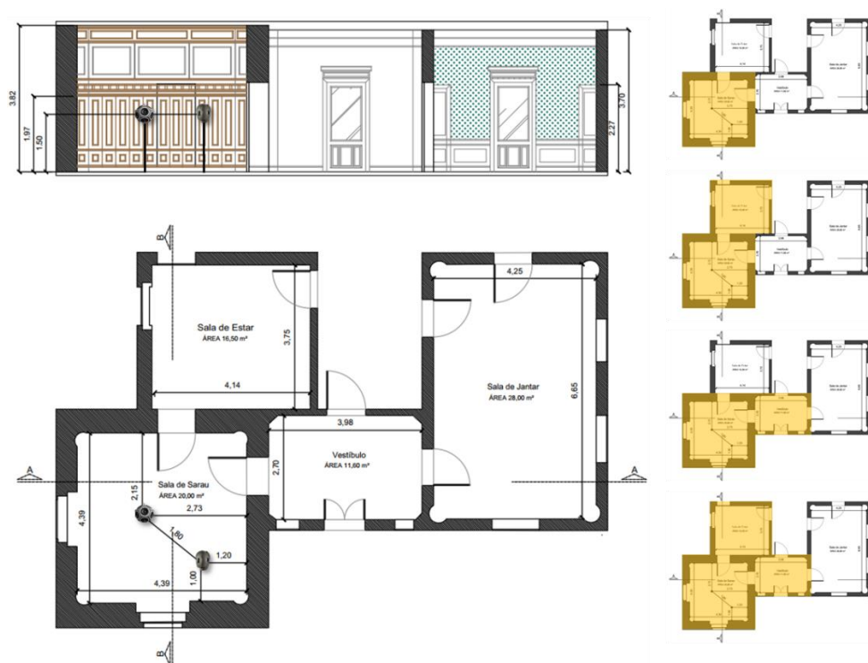
Figura 39: Planta baixa e corte esquemáticos contendo a representação do posicionamento da fonte e do torso e possibilidades de acoplamentos considerados durante e medição dos parâmetros de qualidade sonora na situação 01-a, 01-b, 01-c e 01d.
